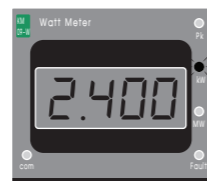
แสดงค่า kW ณ ขณะ ปัจจุบัน
